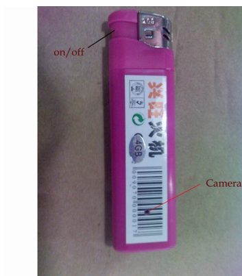
Micro kamera ukrytá v klasickom plastovom zapažovaži 616-L201
